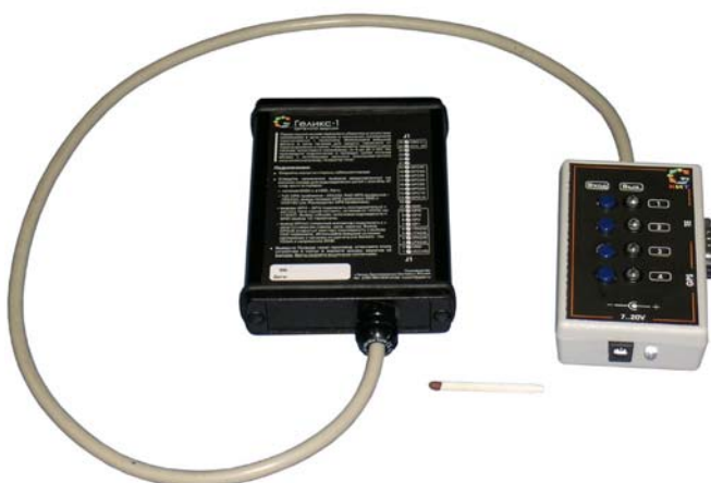
Рис. 4.7. Внешний вид Устройства с эмулятором сигналов Геликс-КИТ.
